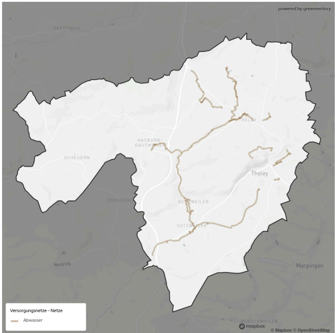
Abbildung 21: Abwassernetze mit Mindestnenngröße DN800
